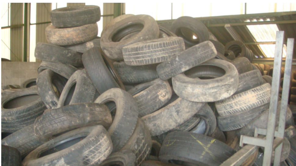
Figura 95 – Seleção dos pneus inservíveis após a 1ª etapa da triagem e seleção, que representa 70% do total coletado em Valinhos – SP.
