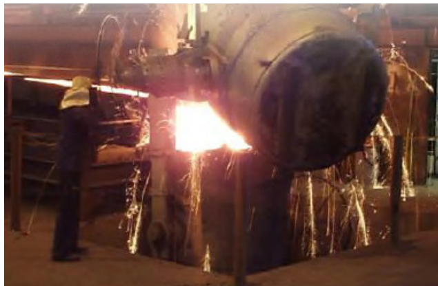
Figura 43 – Utilização de pneus inservíveis triturados no processo de redução da sucata de aço.
