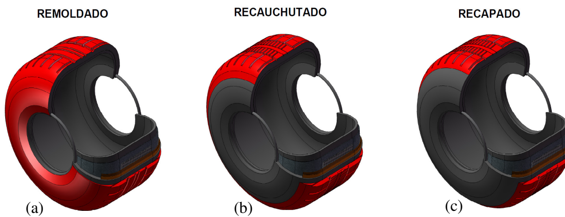
Figura 33 – Pneu remoldado (a), recauchutado (b) e recapado (c) (Elaborado pelo autor).
