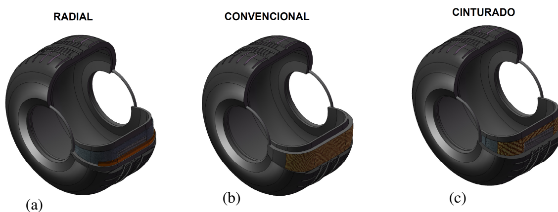
Figura 34 – Seção transversal do pneu radial (a), convencional ou diagonal (b) e cinturado – diagonal (c) (Elaborado pelo autor).
