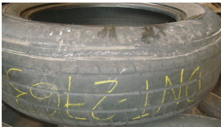
Figura 92 – Pneu inservível com lona exposta, provocada pelo desalinhamento dos pneus.
