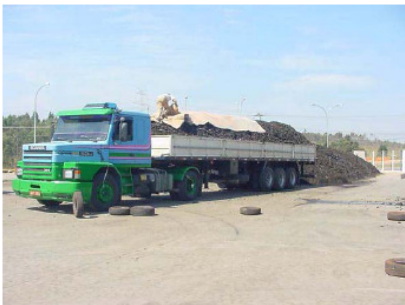
Figura 21 – Carregamento e transporte dos chips de 2" para o coprocessamento na indústria de cimento. Referência: Arnaldi (2003)
