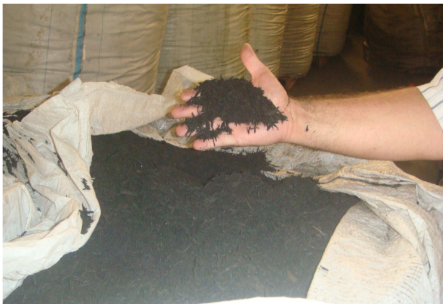
Figura 101 – Pó e lascas de borracha geradas pelo processo de reforma dos pneus de carga.
