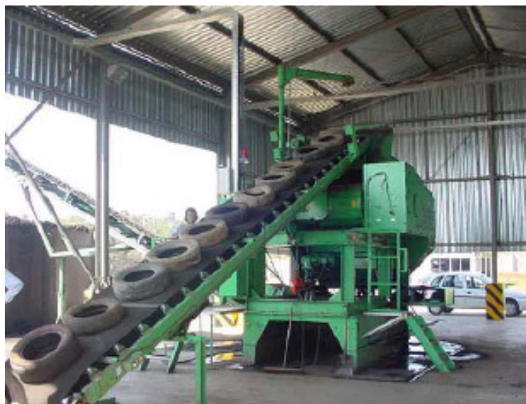
Figura 18 – Trituração dos pneus em chips de 2". Referência: Arnaldi (2003)
