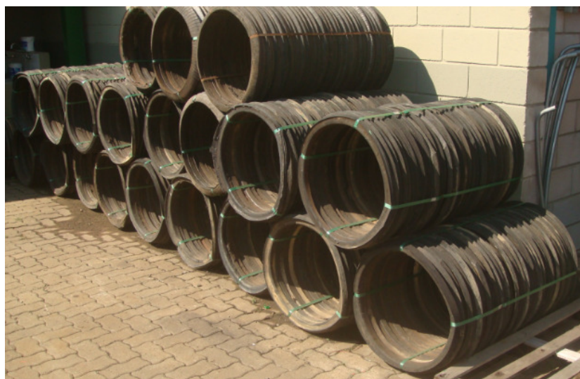
Figura 22 – Dutos de talões removidos dos pneus de carga.
